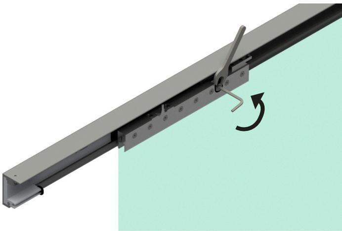
Colgar la hoja corredera del perfil anclado a la pared, encajando las roldanas sobre el rail.
