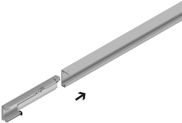
Introducir los sistemas de frenado Softbrake en los extremos del perfil previamente anclado a la pared.
